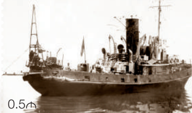
2018 AZƏRBAYCAN Yedək gəmisində quraşdırılmış qazma qurğusu
